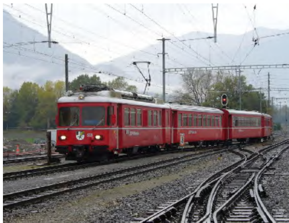
Figura 25: Doppio scartamento Stazione di Untervaz (GR)
